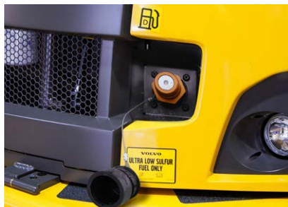
Быстрозаполняемая топливная система
